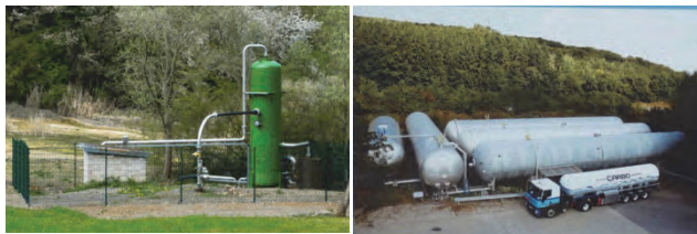
Afvang van CO 2 -gas in absorptietorens en transport van vloeibare CO 2 in tankwagens bij Carbo in Wehr. (foto rechts: CARBO Kohlensäurewerke GmbH & Co, Bad Hönningen).
